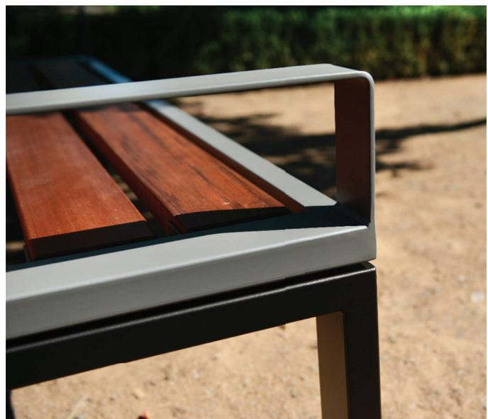
Banquette r alis e en tube acier 80 x 40 et 40 x 40 mm. Dossier et assise en bois exotique prot g  en bout. Les planches de bois section 120 x 35 mm sont fix es par visserie inox.
