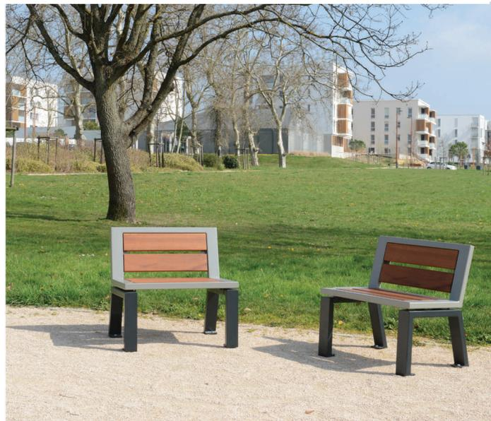
Fauteuil r alis  en tube acier 80 x 40 et 40 x 40 mm. Dossier et assise en bois exotique prot g  en bout. Les planches de bois section 120 x 35 mm sont fix es par visserie inox. Ce produit est   fixer au sol conform ment   la norme NF P99-610 cat gorie "S", par tiges de scellement  $\varnothing$  12 non fournies. Ancrage par 4 points entraxes 665 x 452 mm.
