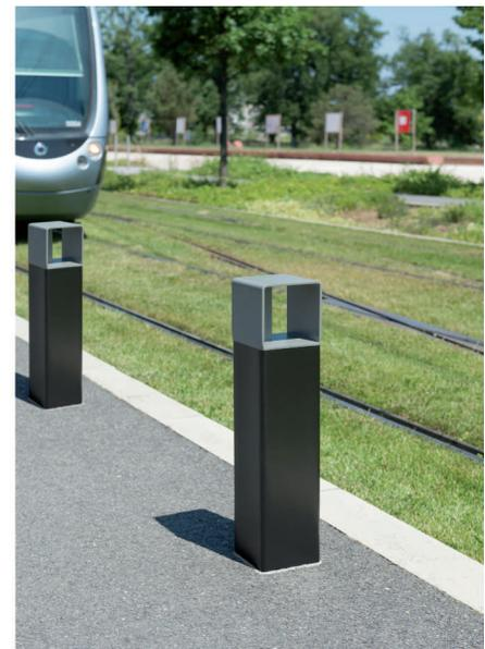
Bornes constitu es d'une partie basse en tube acier et d'une partie haute en acier  p. 6 mm. Syst me amovible tout inox 304L. Verrouillage par serrure quart de tour command e par cl  triangle de 9.
