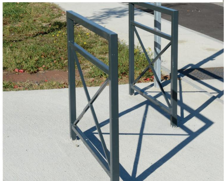
Barrières tout acier. Montants verticaux et main courante en tube de 40 x 40, lices horizontales en tube 30 x 30, croisillon intérieur en carré 16 x 16 mm.
