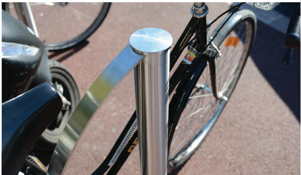
Appui-v lo tout inox compos  d'une t te usin e  $\varnothing$  86, d'un tube  $\varnothing$  76 et d'un plat cintr  50 x 6 mm. Inox 304L.
