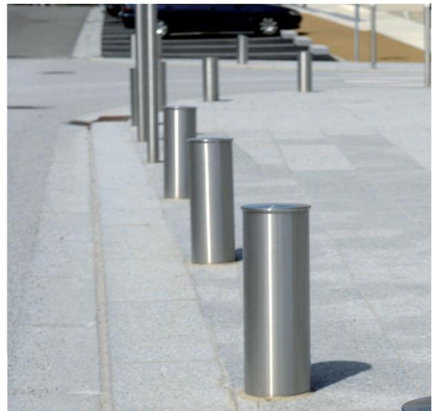
Bornes constitu es d'une t te en acier inoxydable 304L massif usin e soud e sur tube acier inoxydable 304L. Syst me amovible tout inox 304L. Verrouillage par serrure quart de tour command e par cl  triangulaire de 9.
