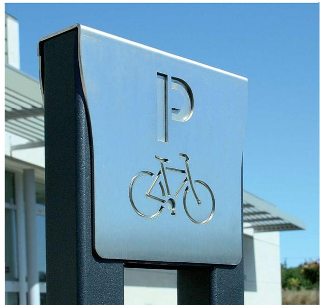
Appui-vélo composé d'un corps en tube acier 40 x 40 mm et d'une partie haute signalétique en inox 304L épaisseur 3 mm.
