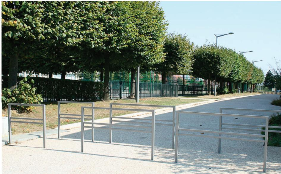
Barri res tout acier. Montants verticaux et main courante en tube de 40 x 40, lices horizontales en tube 30 x 30 mm.
