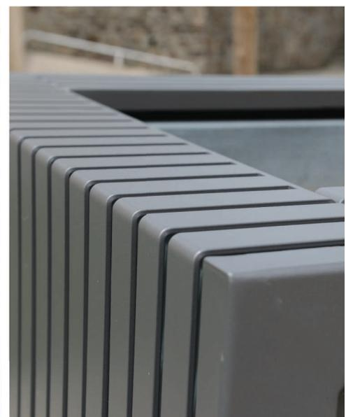
Jardini re constitu e d'un ch ssis en tube acier 70 x 35 et t le  paisseur 4 mm d coup e au laser pli e et renforc e.
