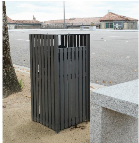
Corbeille constituée d'un Corps en plat de 35 x 5 et profil "T" de 35 x 35 mm et un couvercle en tôle acier ép 5 mm monté sur charnières et verrouillé par serrure quart de tour.
