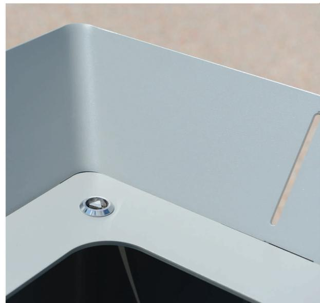
Corbeille constitu e d'un corps en rond acier  $\varnothing 12$  mm et d'un couvercle avec collerette en t le acier  p. 4 mm. Le couvercle est mont  sur charni re et verrouill  par serrure quart de tour. Support de sac int gr  (pr vu pour sac 50 litres). Ancrage par 2 points entraxe 100 mm.
