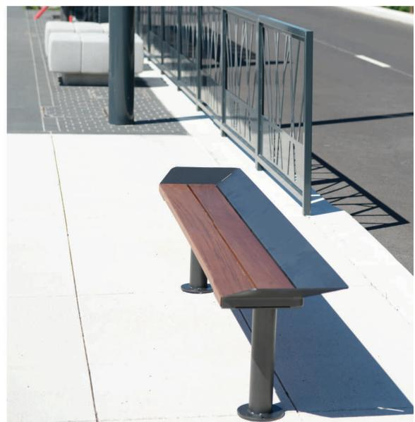
Banquette constituée d'un piètement en tube acier  $\varnothing$  50 x 2 mm et d'une assise en bois exotique. Les planches de bois exotique section 120 x 35 mm sont fixées par visserie inox. Ce produit est à fixer au sol conformément à la norme NF P99-610 catégorie "S", par tiges de scellement  $\varnothing$  12 non fournies. Ancrage par 4 points entraxes 1546 x 120 mm.
