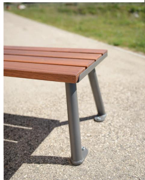
Banquette constitu e d'un pi ement en tube acier  $\varnothing$  50 x 2 mm et d'une assise en bois exotique. Les planches de bois section 120 x 35 mm sont fix es par visserie inox.
