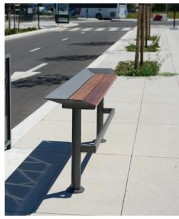
Assis debout constitué d'un piètement en tube acier ø 76 mm et d'une assise en bois exotique protégé en bout par un habillage en acier ep. 4 mm. Les planches de bois section 120 x 35 mm sont fixées par visserie inox. Repose pieds en tube 60 x 30 mm
