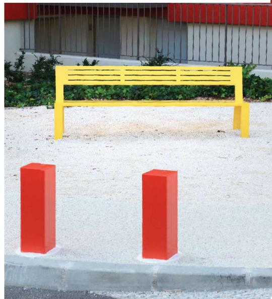
Bornes constitu es d'une t te en acier massif usin e soud e sur tube acier. Syst me amovible tout inox 304L. Verrouillage par serrure quart de tour command e par cl  triangle de 9.
