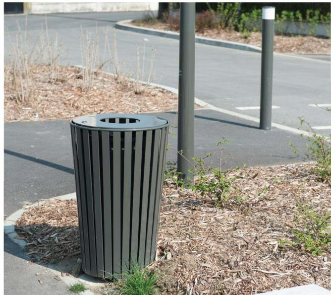
Corbeille constitu e d'un couvercle t le acier  p 5 mm mont  sur charni re renforc e. Corps en plat acier de 35 x 5 mm, cerclage sup rieur en rond   12 mm
