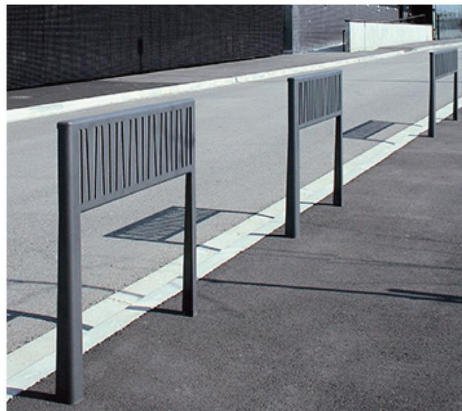
Barrières réalisées en acier plié. Montants verticaux épaisseur 8 mm, partie haute ajourée avec main courante épaisseur 6 mm. A sceller profondeur 200 mm. 2 trous  $\varnothing$  12 mm au bas des montants.
