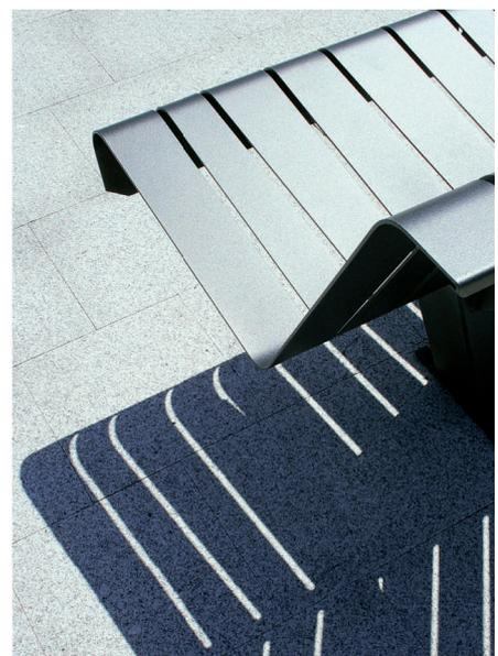
Banc r alis  en tube acier 120 x 120 et U 120 x 60 mm, dossier et assise en t le acier  p. 3 mm soud s sur pi tement. Ce produit est   fixer au sol conform ment   la norme NF P99-610 cat gorie "S", par tiges de scellement   12 non fournies. Ancrage par 4 points entraxes 1172 x 170 mm.
