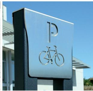
Appui-vélo composé d'un corps en tube acier  $40 \times 40 \text{ mm}$  et d'une partie haute signalétique en inox 304L épaisseur 3 mm. A sceller profondeur 200 mm.
