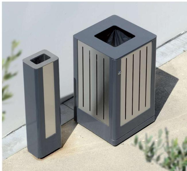
Corbeille constitu e d'un ch ssis en t le acier  p 5 mm et d'habillages en t le inox 304L  p. 3 mm. Porte lat rale verrouill e par serrure quart de tour command e par cl  triangle de 9. Bac int rieur poly thyl ne de 75 litres avec poign es. Ancrage par 4 points entraxes 240 x 250 mm.
