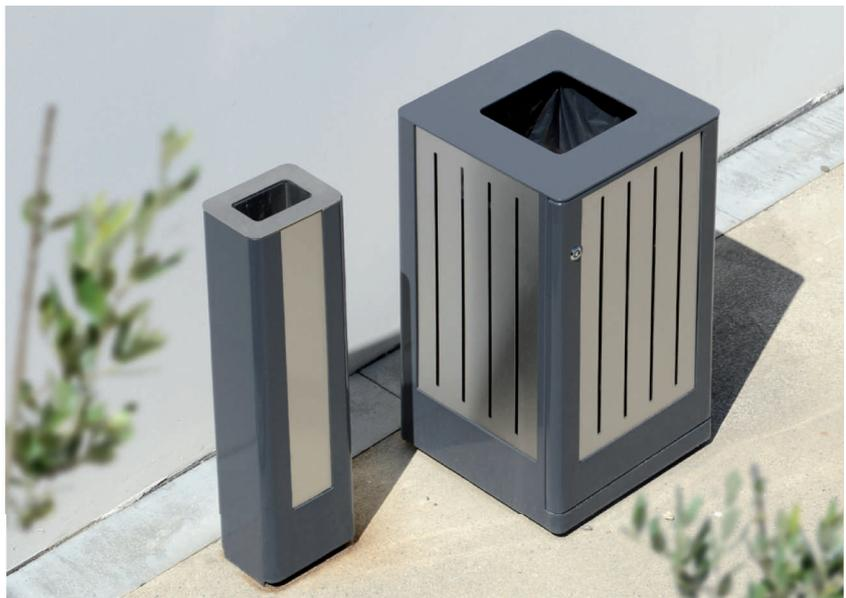
Cendrier constitué d'un châssis en tôle acier ép 3 mm, d'un couvercle en inox 304L ép. 4 mm et d'habillages en tôle inox 304L ép 3 mm.
