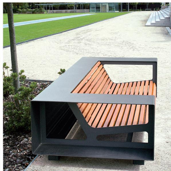
Canap  r alis  en t le acier  paisseur 6 mm, pieds en tube acier 100 x 100 mm, dossier et assise en bois exotique. Les planches de bois section 38 x 35 mm sont fix es par visserie inox. Ce produit est   fixer au sol conform ment   la norme NF P99-610 cat gorie "S", par tiges de scellement M12 non fournies. Ancrage par 4 points entraxes 1900 x 830 mm.
