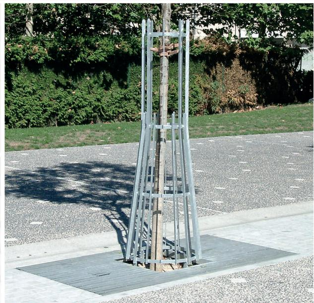
Corset constitué de montants verticaux en plat acier de 25 x 6, cerclages en plat acier cintré de 25 x 5 mm. Composé de deux demi-éléments fixés entre-eux par visserie M6. A fixer sur grille d'arbre Univers & Cité par visserie M10.
