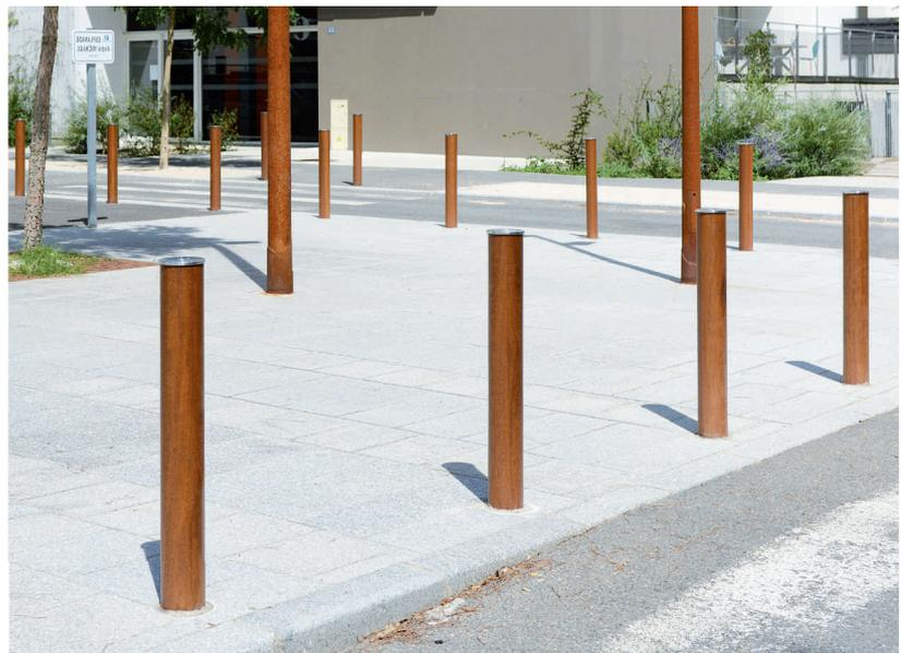
Bornes constitu es d'une t te en acier inoxydable 304L fix e sur un corps en bois exotique tourn .
