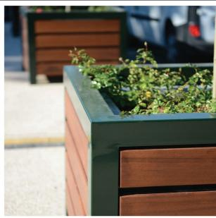
Jardinière constituée d'un châssis en tube acier  $80 \times 80$  et d'un habillage en bois exotique section  $120 \times 35$  mm. Bac intérieur en tôle acier galvanisé épaisseur 2,5 mm renforcé par un cadre en tube  $30 \times 30$  mm.
