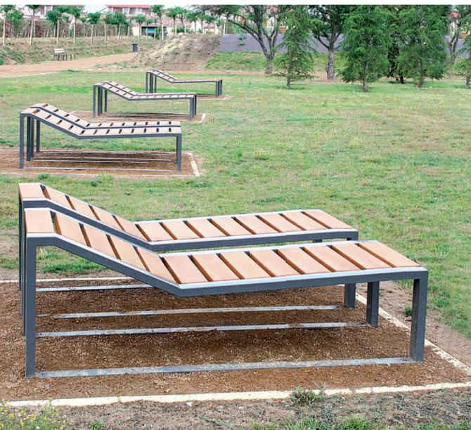
Chaise longue constitu e d'un pi ement en tube acier 80 x 40 mm et d'une assise en bois exotique prot g  en bout par les pieds. Les planches de bois section 120 x 35 mm sont fix es par visserie inox.
