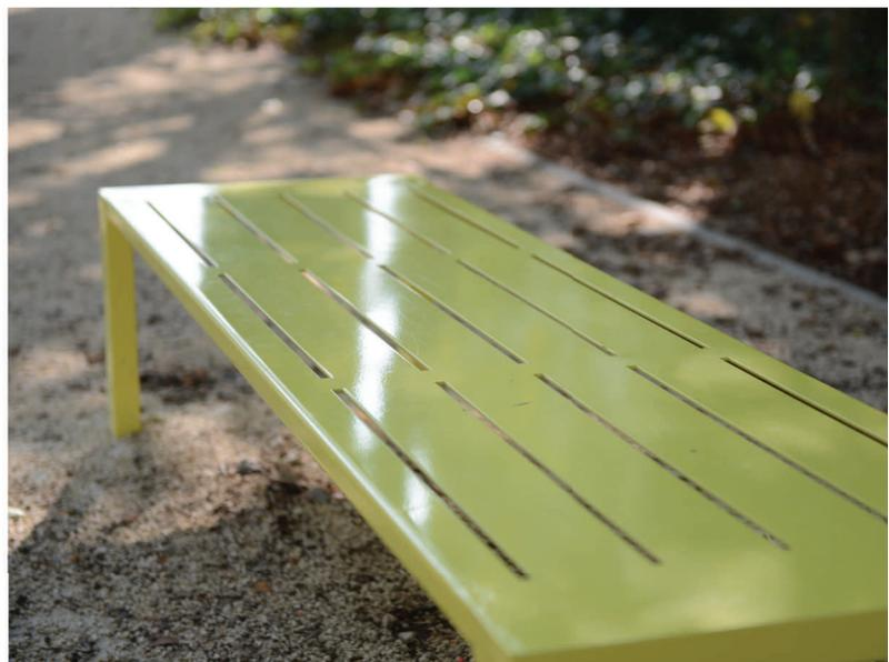
Banquette réalisée en tube acier 80 x 40 mm, assise en tôle acier ép. 4 mm soudée sur les pieds.
