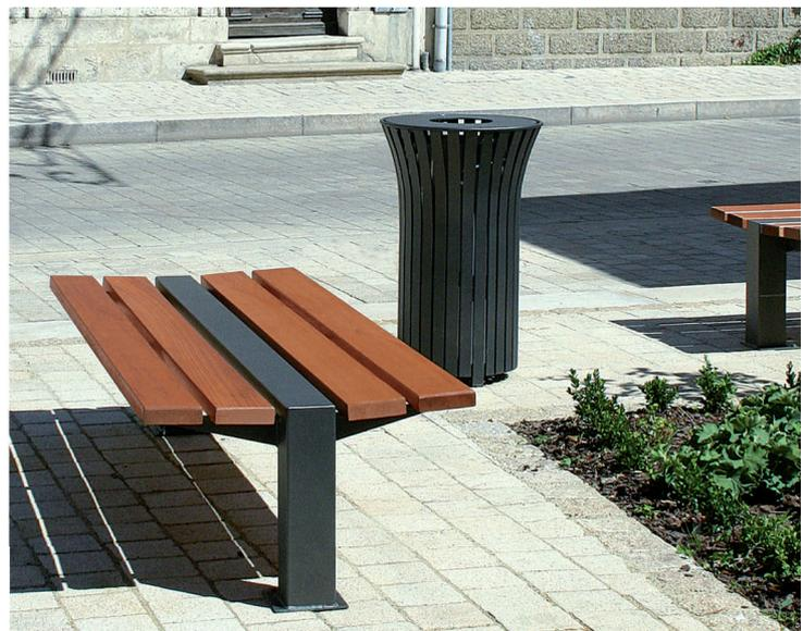
Fauteuil constitu  d'un pi tement en tube acier 100 x 100 mm et d'une assise en bois exotique. Les planches de bois section 120 x 35 mm sont fix es par visserie inox. Ce produit est   fixer au sol conform ment   la norme NF P99-610 cat gorie "S", par tiges de scellement  $\varnothing$  12 non fournies. Ancrage par 4 points entraxes 130 x 130 mm.
