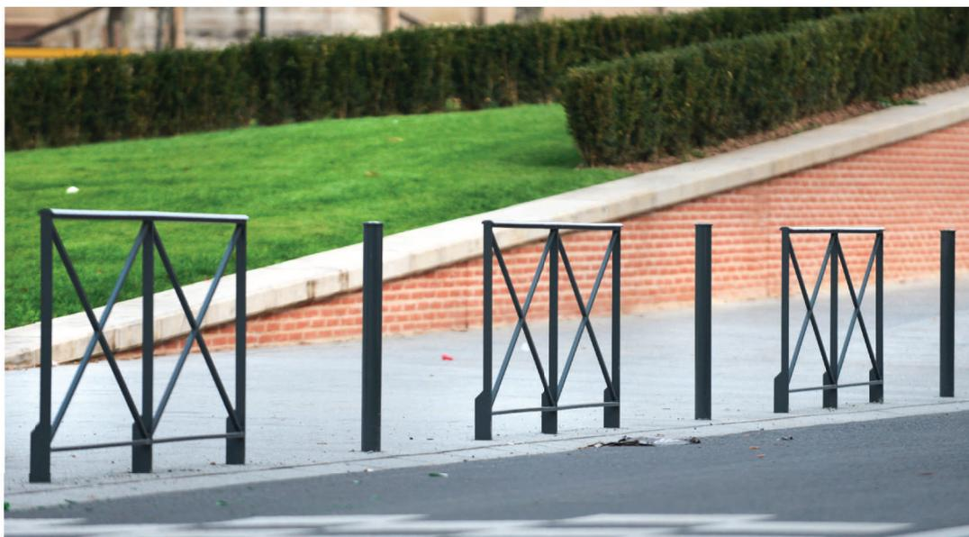
Barri res tout acier. Montants verticaux en plat 35 x 15, croisillon int rieur en carr  de 18, main courante de 55 mm. A sceller profondeur 200 mm. 2 trous  $\varnothing$  12 mm au bas des montants.
