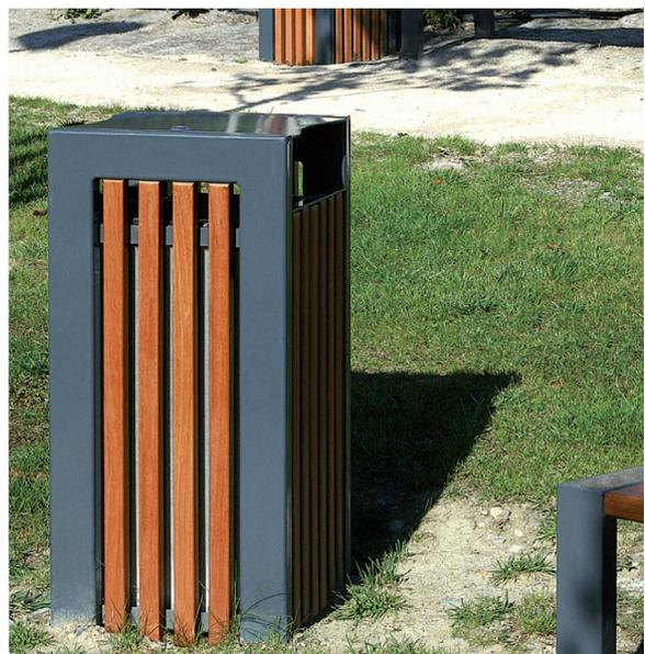
Corbeille constituée d'un châssis en tube acier 80 x 40 mm avec des lattes de bois exotique 30 x 35 mm. Couvercle en tôle acier ép. 5 mm monté sur charnières verrouillées par serrure quart de tour.
