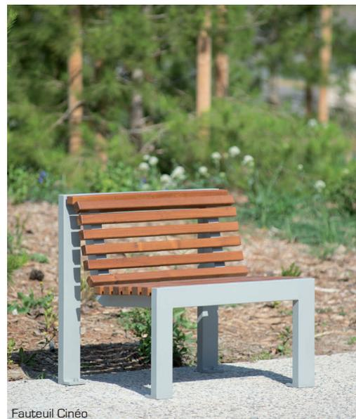
Banc constitué d'un piètement en tube acier 80 x 40 mm, dossier et assise en bois exotique. Les planches de bois section 38 x 35 mm sont fixées par visserie inox.
