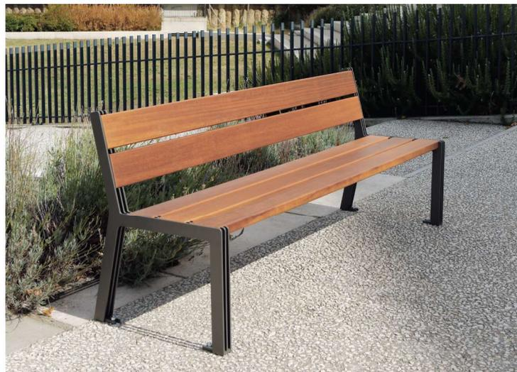
Banc constitu  d'un pi tement en acier ep.6 mm, d'un dossier et d'une assise en bois exotique prot g  en bout par les pieds. Les planches de bois section 120 x 35 mm sont fix es par visserie inox.
