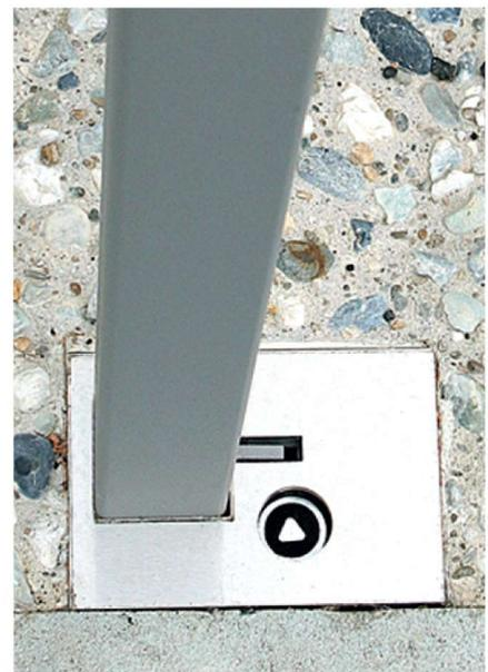
Barrières composées d'une partie haute en tube inox 304L et d'une partie basse en acier. Système amovible tout inox 304L. Verrouillage par serrure quart de tour commandée par clé triangle de 9.
